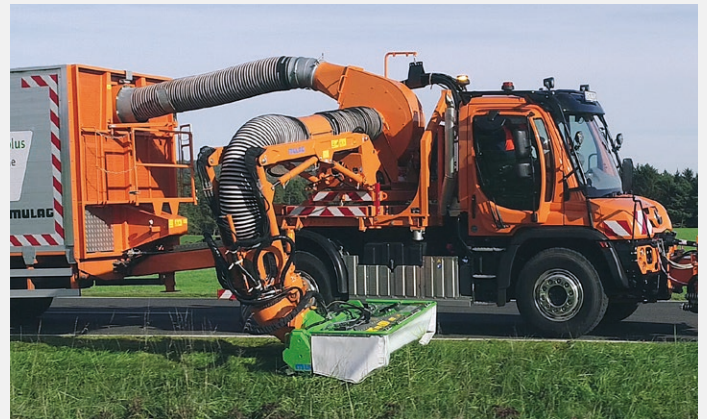
Heckausleger SB 600 mit angebautem Grünpflegekopf ECO 1200 plus
