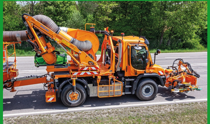
Transportstellung SB 600 mit Grünpflegekopf ECO 1200 plus
