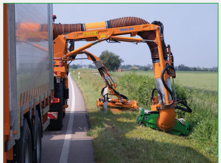
Große Reichweite – Heckauslegermähgerät SB 600 mit ECO 1200 plus
